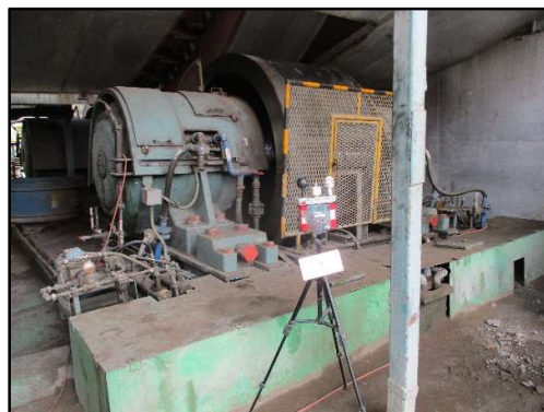
ภาพที่ 3.143 การตรวจวัดความร้อนในสถานที่ทำงานบริเวณลูกกลิ้งแท่น 1
