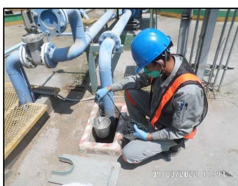
ภาพที่ 3.56 การตรวจวัดคุณภาพน้ำ บริเวณ Regenerate resin ที่ระบายลงสู่บ่อเก็บน้ำทิ้งรวม
