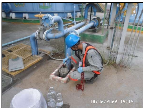
ภาพที่ 3.56 การตรวจวัดคุณภาพน้ำ บริเวณ Regenerate resin ที่ระบายลงสู่บ่อเก็บน้ำทิ้งรวม
