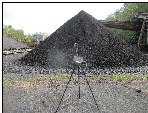
ภาพที่ 3.72 การตรวจวัดฝุ่นในสถานที่ทำงาน บริเวณกอง Coal
