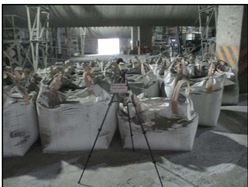
ภาพที่ 3.103 การตรวจวัดระดับเสียงบริเวณ เครื่องจักรบริเวณ Cement Mill 2
