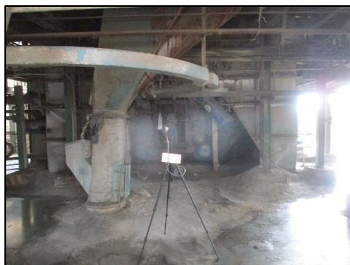
ภาพที่ 3.71 การตรวจวัดฝุ่นในสถานที่ทำงาน บริเวณ Riser pipe ชั้นที่ 1
