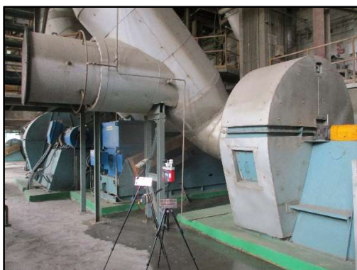
ภาพที่ 3.148 การตรวจวัดความร้อนในสถานที่ ทำงานบริเวณข้างพัดลม 920 B12M
