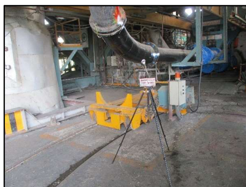
ภาพที่ 3.70 การตรวจวัดฝุ่นในสถานที่ทำงาน บริเวณ Cooler และ Kiln
