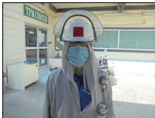
ภาพที่ 3.85 การตรวจวัดฝุ่นที่ติดตัวพนักงาน พนักงานประจำ หน้า Main Burner
