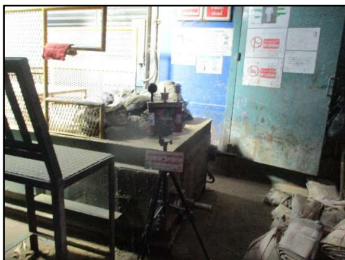
ภาพที่ 3.142 การตรวจวัดความร้อนในสถานที่ทำงานบริเวณที่คนทำงานตรงจุด Feed Waste ชั้น Waste Lift
