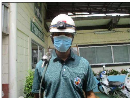
ภาพที่ 3.84 การตรวจวัดฝุ่นที่ติดตัวพนักงาน พนักงานประจำหม้อเผา
