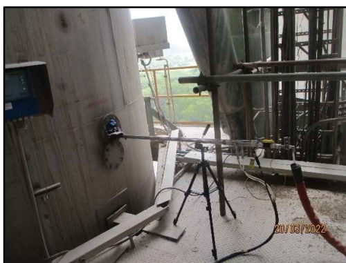
ภาพที่ 3.24 การตรวจวัด HCl และ HF จากปล่องหม้อเผา
