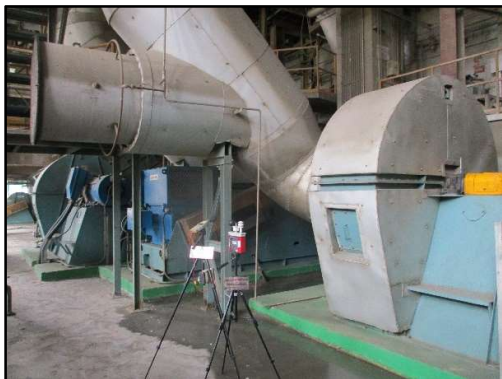
ภาพที่ 3.109 การตรวจวัดระดับเสียงบริเวณเครื่องจักร บริเวณพัดลมข้าง 920 B12M
