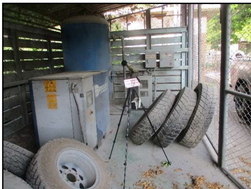
ภาพที่ 3.101 การตรวจวัดระดับเสียงบริเวณ เครื่องจักรบริเวณห้อง Compressor
