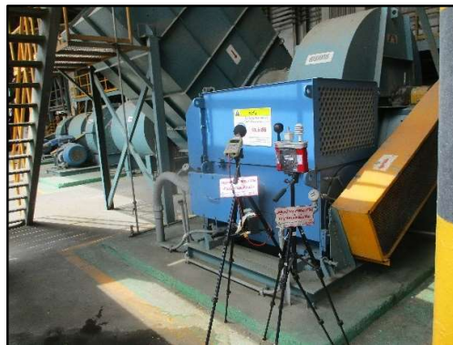
ภาพที่ 3.110 การตรวจวัดระดับเสียงบริเวณเครื่องจักร บริเวณพัดลมข้าง 920 B16M
