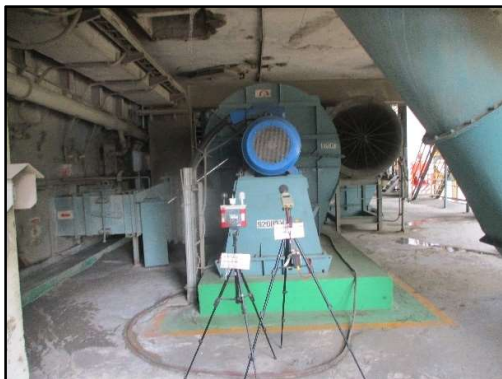
ภาพที่ 3.107 การตรวจวัดระดับเสียงบริเวณเครื่องจักร บริเวณพัดลมข้าง 920 B3M
