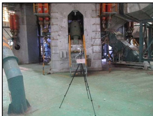
ภาพที่ 3.75 การตรวจวัดฝุ่นในสถานที่ทำงาน บริเวณหม้อบดวัตถุดิบ 2
