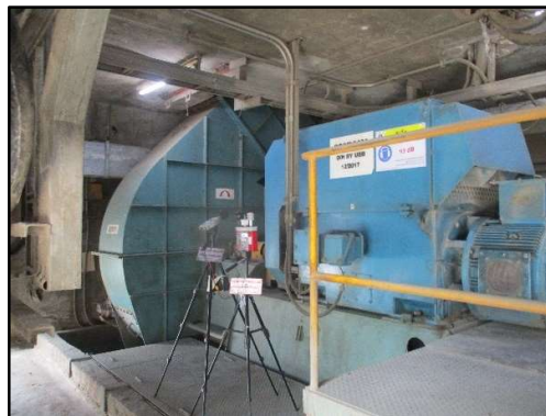
ภาพที่ 3.108 การตรวจวัดระดับเสียงบริเวณ เครื่องจักรบริเวณพัดลมข้าง 920 B11 M
