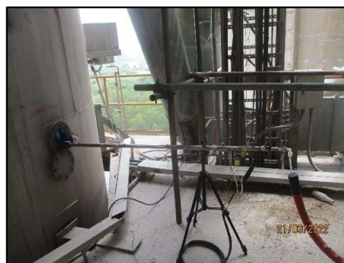
ภาพที่ 3.18 การตรวจวัดไดออกซิน จากปล่องหม้อเผา
