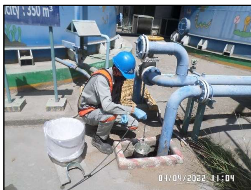
ภาพที่ 3.56 (ต่อ) การตรวจวัดคุณภาพน้ำ บริเวณ Regenerate resin ที่ระบายลงสู่อุโมงค์น้ำทิ้งรวม
