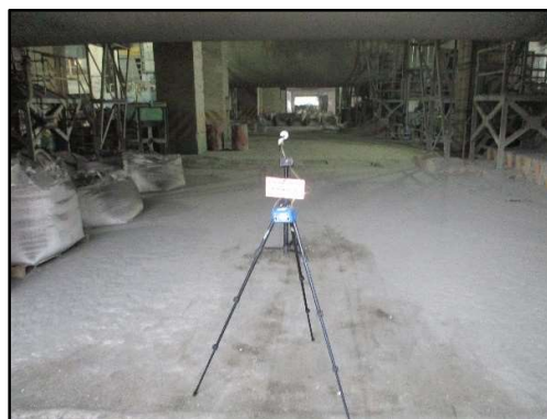
ภาพที่ 3.76 การตรวจวัดฝุ่นในสถานที่ทำงาน บริเวณ Cement Mill 1
