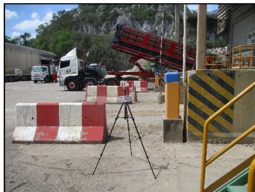
ภาพที่ 3.68 การตรวจวัดฝุ่นในสถานที่ทำงาน บริเวณระหว่าง Clay/Shale Crusher
