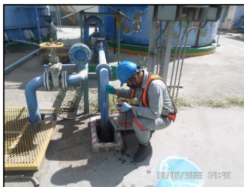
ภาพที่ 3.56 (ต่อ) การตรวจวัดคุณภาพน้ำ บริเวณ Regenerate resin ที่ระบายลงสู่อุโมงค์น้ำทิ้งรวม
