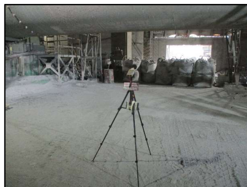
ภาพที่ 3.104 การตรวจวัดระดับเสียงบริเวณ เครื่องจักรบริเวณ Cement Mill 3
