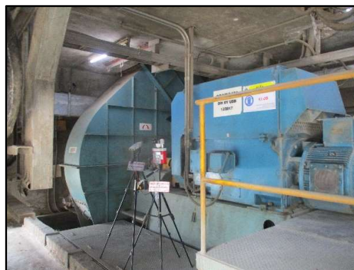
ภาพที่ 3.147 การตรวจวัดความร้อนในสถานที่ ทำงานบริเวณข้างพัดลม 920 B11M
