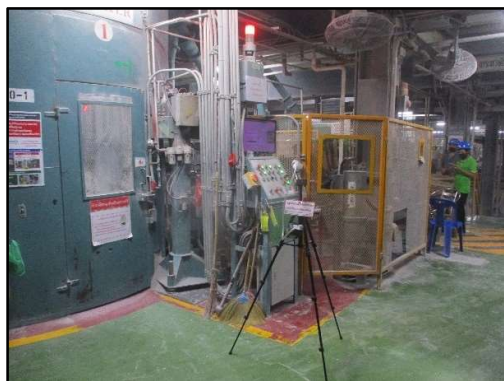
ภาพที่ 3.79 การตรวจวัดฝุ่นในสถานที่ทำงาน บริเวณ Packer 1-5
