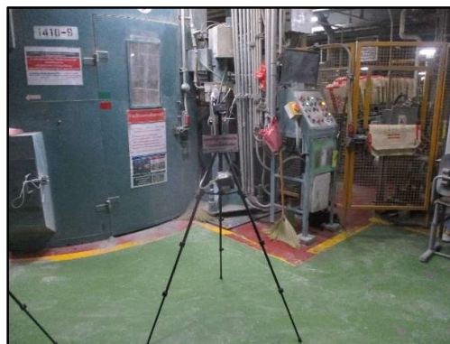
ภาพที่ 3.80 การตรวจวัดฝุ่นในสถานที่ทำงาน บริเวณ Packer 6-10
