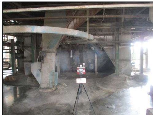
ภาพที่ 3.141 การตรวจวัดความร้อนในสถานที่ทำงานบริเวณ Riser Pipe ชั้น 1
