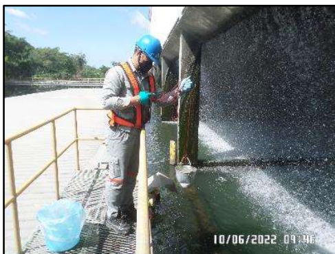
ภาพที่ 3.55 การตรวจวัดคุณภาพน้ำบริเวณ Cooling Tower
