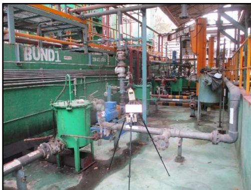
ภาพที่ 3.111 การตรวจวัดระดับเสียงบริเวณเครื่องจักร บริเวณปั๊มสุญญากาศของเสียที่เป็นของเหลว
