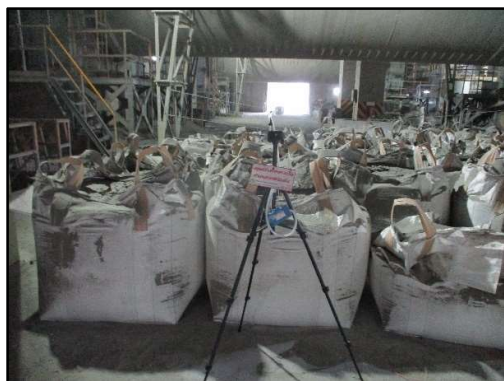
ภาพที่ 3.77 การตรวจวัดฝุ่นในสถานที่ทำงาน บริเวณ Cement Mill 2
