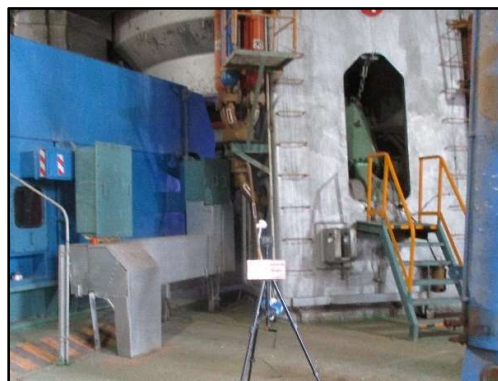
ภาพที่ 3.74 การตรวจวัดฝุ่นในสถานที่ทำงาน บริเวณหม้อบดวัตถุดิบ 1
