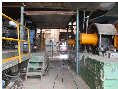
ภาพที่ 3.145 การตรวจวัดความร้อนในสถานที่ทำงานบริเวณลูกกลิ้งแท่น 3
