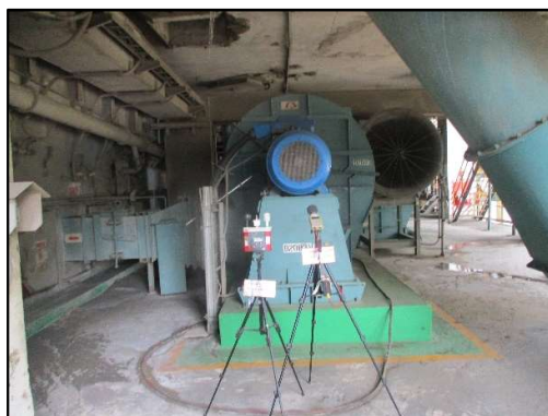
ภาพที่ 3.150 การตรวจวัดความร้อนในสถานที่ทำงานบริเวณข้างพัดลม 920 B3M
