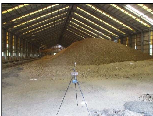
ภาพที่ 3.69 การตรวจวัดฝุ่นในสถานที่ทำงาน บริเวณยั้ง Mixed Mat ป้อมยามเหมือง
