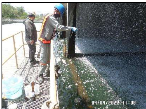
ภาพที่ 3.55 การตรวจวัดคุณภาพน้ำบริเวณ Cooling Tower
