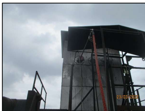
ภาพที่ 3.20 การตรวจวัด TSP จากปล่องหม้อบดลิกไนต์ 2
