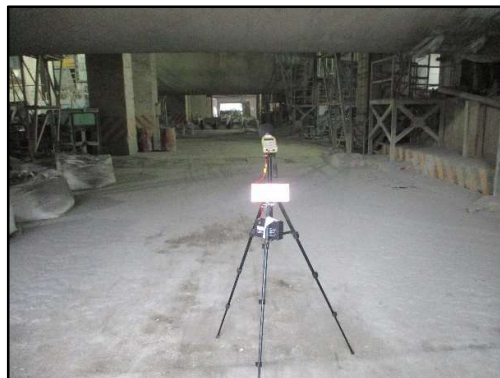
ภาพที่ 3.102 การตรวจวัดระดับเสียงบริเวณ เครื่องจักรบริเวณ Cement Mill 1
