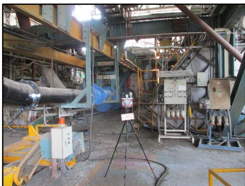
ภาพที่ 3.146 การตรวจวัดความร้อนในสถานที่ ทำงานบริเวณหน้า Main Burner
