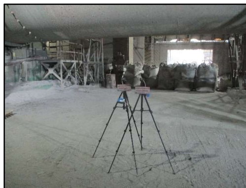
ภาพที่ 3.78 การตรวจวัดฝุ่นในสถานที่ทำงาน บริเวณ Cement Mill 3
