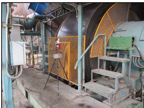
ภาพที่ 3.144 การตรวจวัดความร้อนในสถานที่ทำงานบริเวณลูกกลิ้งแท่น 2
